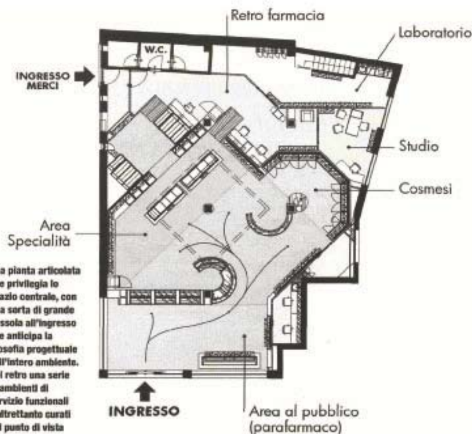
Poco prima delle postazioni del farmaco etico, è stato previsto un grande banco accoglienza/informazioni, di forma semicircolare realizzato con una struttura metallica laccata e un tamponamento in metacrilato retroilluminato
