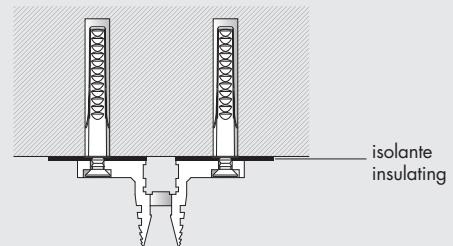
il fissaggio a parete del montantelettrico deve essere eseguito da personale qualificato utilizzando viti e tasselli adeguati al supporto di installazione.
