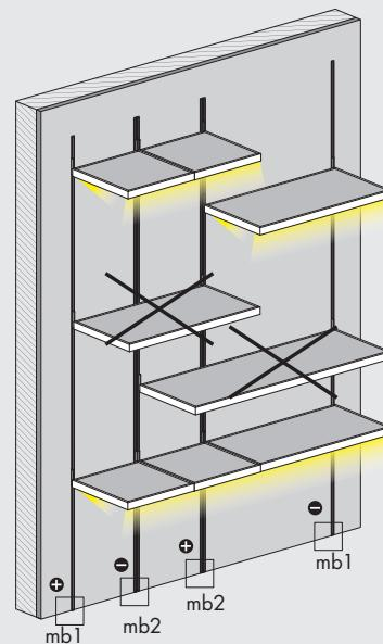
**attenzione:** l'accensione delle men sole avviene solo se innestate su un montantelettrico + e un montantelettrico -
