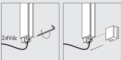
**attenzione:** l'accensione delle men sole avviene solo se innestate su un montantelettrico + e un montantelettrico -
