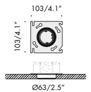
**copertura per outlet box. cover for outlet box**
