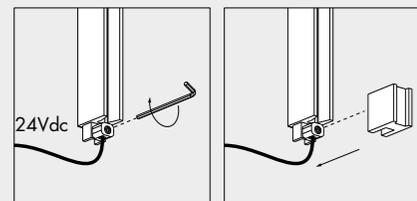
**attenzione:** l'accensione delle men sole avviene solo se innestate su un montantelettrico + e un montantelettrico -
