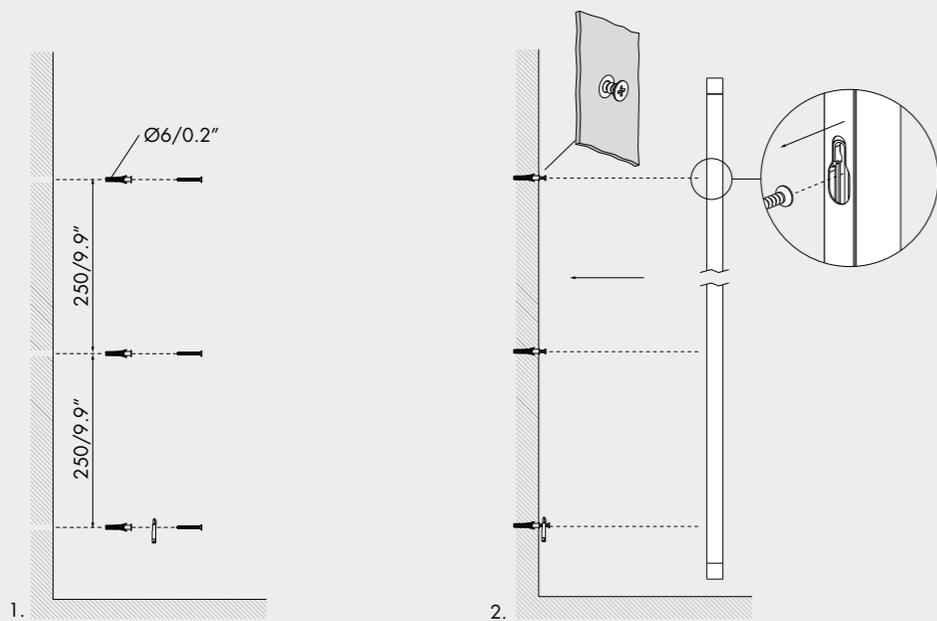
il fissaggio a parete del montantelettrico deve essere eseguito da personale qualificato utilizzando viti e tasselli adeguati al supporto di installazione. condizioni ambientali di funzionamento: temperatura ambiente max 35°C, umidità relativa max 80%.
