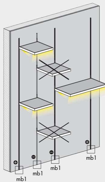
collegamento elettrico - electrical connection
