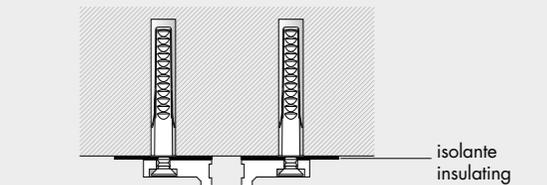
il fissaggio a parete del montantelettrico deve essere eseguito da personale qualificato utilizzando viti e tasselli adeguati al supporto di installazione. condizioni ambientali di funzionamento: temperatura ambiente max 35°C, umidità relativa max 80%.
