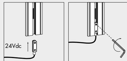
collegamento elettrico · electrical connection
