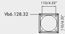
interasse fori di installazione · installation hole distance
