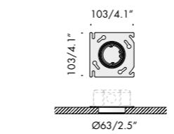
**copertura per outlet box. cover for outlet box**
