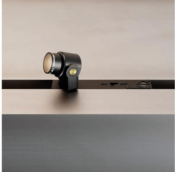
apparecchio di illuminazione per interni IP20 realizzato in alluminio anodizzato nero55. dimensioni faretto Ø14mm h.18mm, cablato con sorgente elettronica 2700K o 3000K 0,9W fino a 117lm con ottiche 12° e 23° con antiabbagliamento 12° e 25°.
