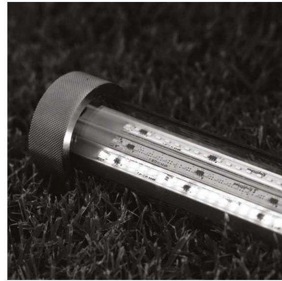
apparecchio di illuminazione da terra, parete, soffitto e sospensione da interno ed esterno IP67. realizzato con un cilindro in vetro pyrex di spessore 2,8mm e diametro Ø34mm, chiuso all'estremità con tappi in acciaio inox AISI 316L diametro Ø45mm: uno cieco e uno con connettore IP67 maschio quattro poli. cablato con sorgente elettronica 3000K, 4000K e 5000K Ra95 26,1W per 672mm, 37,8W per 972mm, 49,5W per 1272mm e 57,3W per 1472mm. con emissione diffusa 84°x110°.
